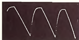
Bild 101. Ausgangsspannung eines Sanatrons bei relativ schwacher Zeitdehnung; die Warzeit ist kurz gegenüber der Hinlaufzeit
