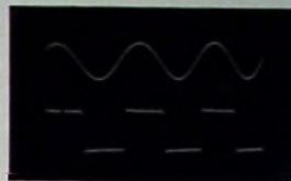
Bild 107. Eine aus einer Sinusspannung (oben) gewonnene Rechteckspannung (unten), aus der man durch Differenzierung Signale für Zeitmarken, Eichfrequenzen usw. ableiten kann ▶
